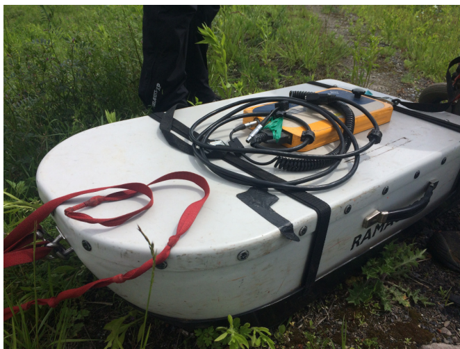
Obrázek č. 4 Měření metodou georadarového měření GPR (ilustrační foto)
