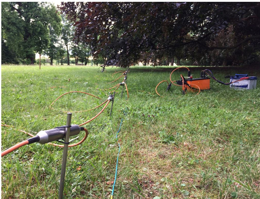
Obrázek č. 3 Pohled na měřící elektrody metody ERT (ilustrační foto)
